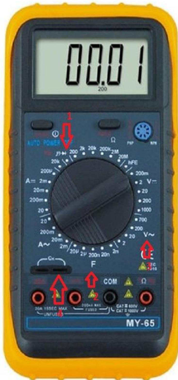
Allora questo è la tipologia di multimetro che ti serve per fare tutti i controlli importante è che abbia il capacimetro che ci aiuta a vedere se il condensatore va o no.
