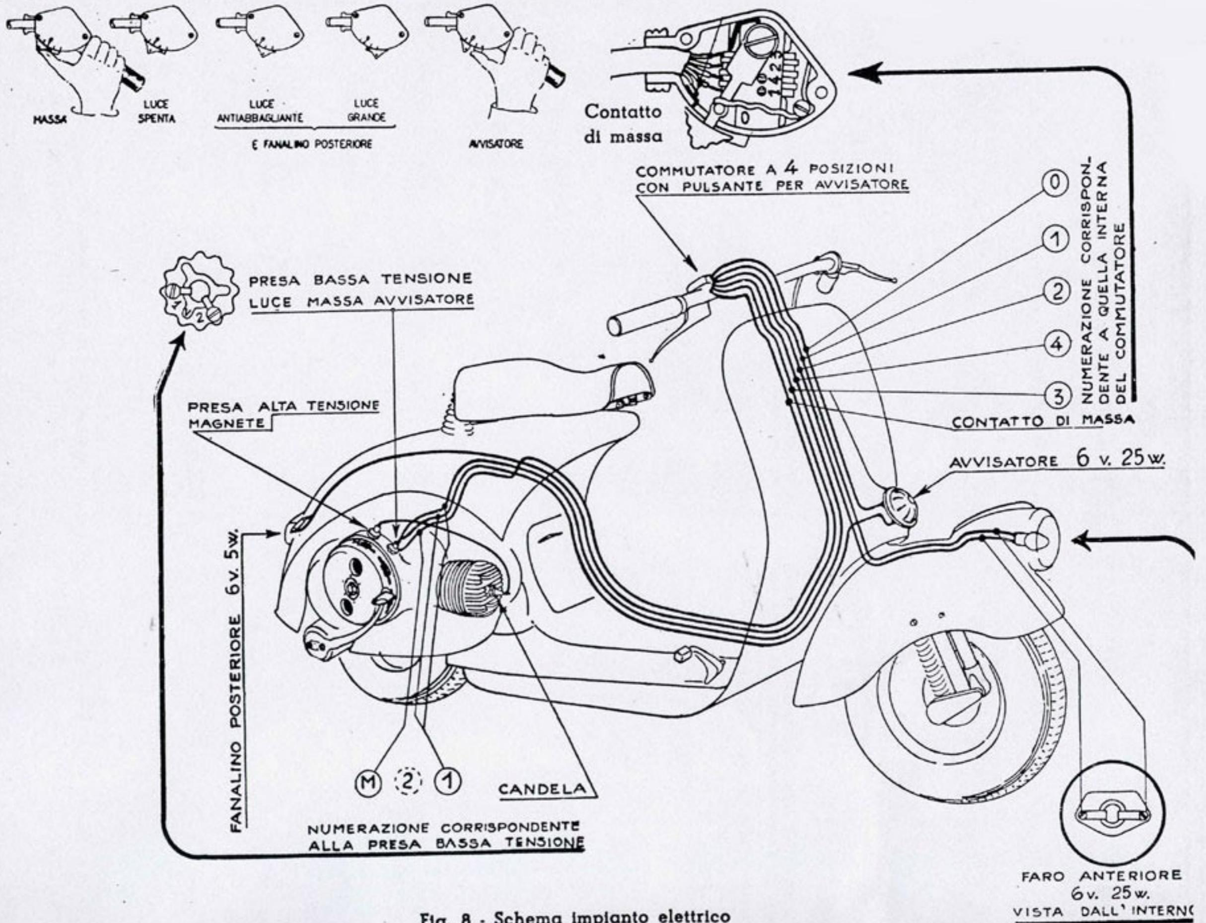
Fig. 8 - Schema impianto elettrico
